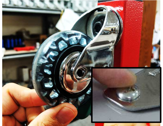
14) Replace end cap on the base tube.
